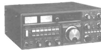
Ricetrasmittitore VHF/UHF per emissioni contemporanee in duplex, USB-LSB-CW-FM, potenza 10 W.
