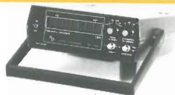
Frequenzimetro Digitale 1 GHz Mod. 2045DF
