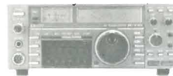
ICOM IC 735 Ricetrasmittitore HF in SSB/CW/AM/FM, 12 memorie, 0,1-30 MHz, completo di filtro FL 35 (500 Hz) potenza 100 watts rf.
