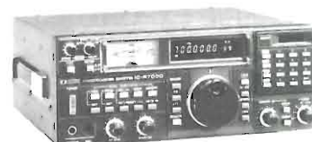
ICOM ICR 7000 Ricevitore-scanner 25-2000 MHz
