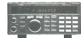
Ricevitore-scanner a copertura continua AM-FM, da 60 a 905 MHz. All Mode.
