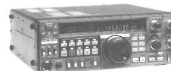
Ricetrasmittitore HF, 160-80-40-30-20-17-15-12-10 mt, RX da 150 kHz a 30 MHz.
